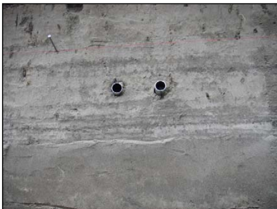
Figur 13. Fra profil H i felt A blev der udtaget prøver for OSL datering. Metalrør blev banket ind i udvalgte lag i profilen. Rørene fyldte med sand og enderne blev lukket efter udtagelse. Foto S. Diinhoff.
