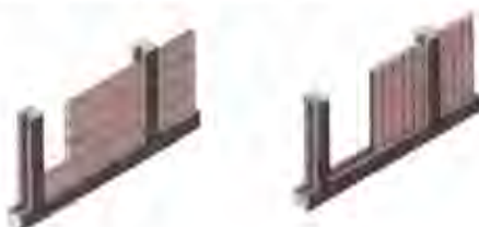
Fig. 10. Vægkonstruktion i henholdsvis sleppverk i sylstok og stav i sylstok. Grafik E. Ethelberg et al. 2003.
