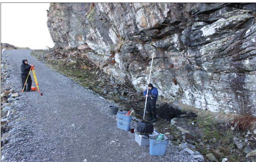
Figur 20. Det ble i forkant av gravingen lagt ut fastpunkt med totalstasjon, mens vi ved undersøkelsene benyttet nivelleringskikkert til høydemål. Her ser vi Yvonne ved kikkerten mens Camilla noterer målene på tegningen.
