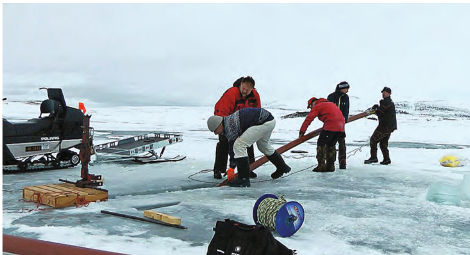
Feltarbeid fra innsjøisen på Store Finnsjøen (1260 moh) på Dovre. Et 12 m langt, 11 cm plastrør er slått ned i bunnavsetningene og hentes opp igjen fylt av "arkiv"-materiale som skal analyseres (foto: Espen Paus).
