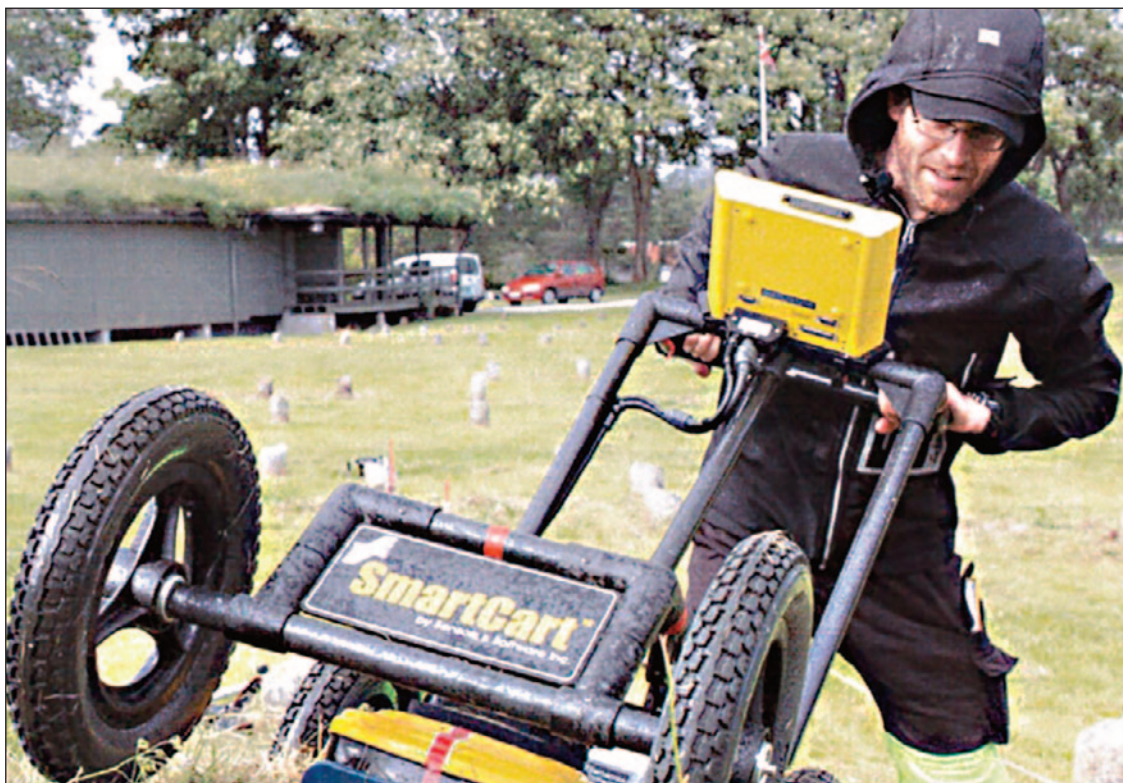
Lars Gustavsen fra NIKU med georadaren på Borgund 6. juli 2013. På jakt etter ny kunnskap.
