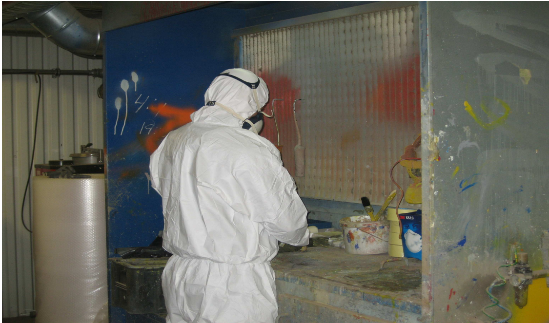
Figur 6.4. Her er en “blandeplass”, der man blander sammen forskjellige malinger, og forbereder arbeidet. Dette er en arbeidsoperasjon som kan gi høy eksponering for kjemiske stoffer, og det er viktig at ventilasjonen er god når man blander stoffer sammen. Denne blandeplassen er godt ventilert med eget avsug.
