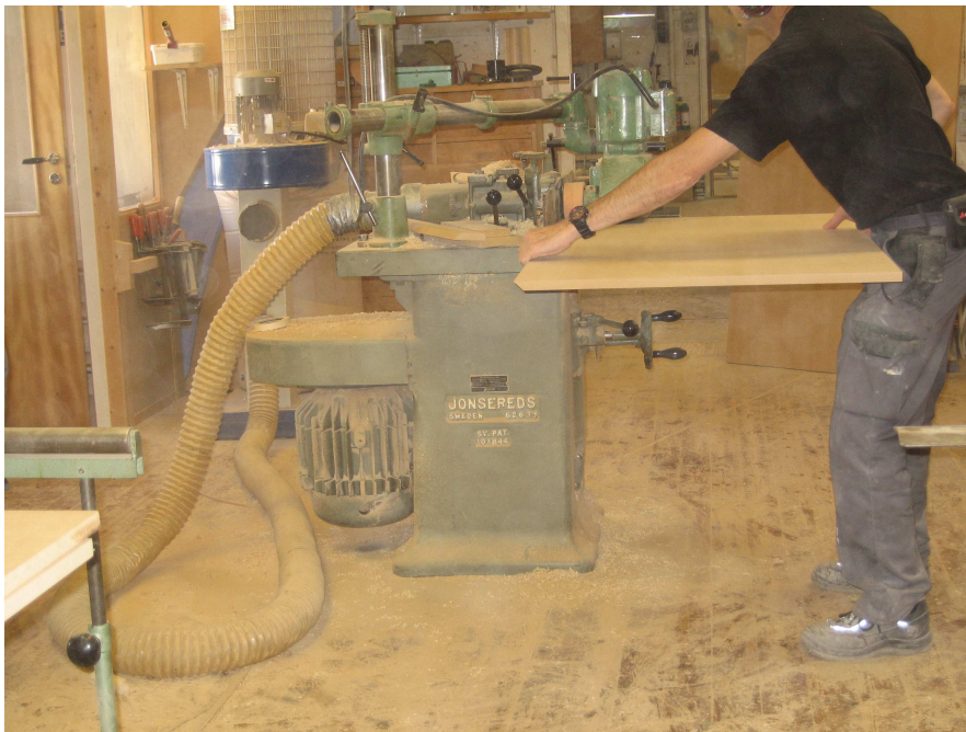
Figur 6.9. I snekkerverksteder oppstår det ofte støv, slik som her når materialer sages til. En god løsning er å ha lokale avsug, slik som her til venstre i bildet. Avsug er koblet så den suger opp sagmugg, og man unngår støv i rommet.
