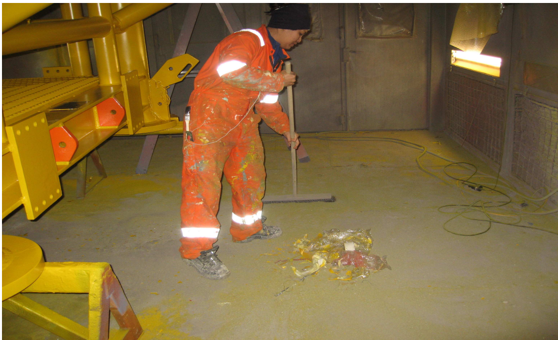
Figur 6.7. Det er viktig med orden og renhold på en slik arbeidsplass, slik at tvistdotter med maling ikke ligger og damper av på gulvet, eller støv samler seg. Kosting kan være bra på små områder, men medfører ofte en betydelig støveksponering for arbeidstakeren, og oppsuging med støvsuger er en betydelig bedre løsning.
