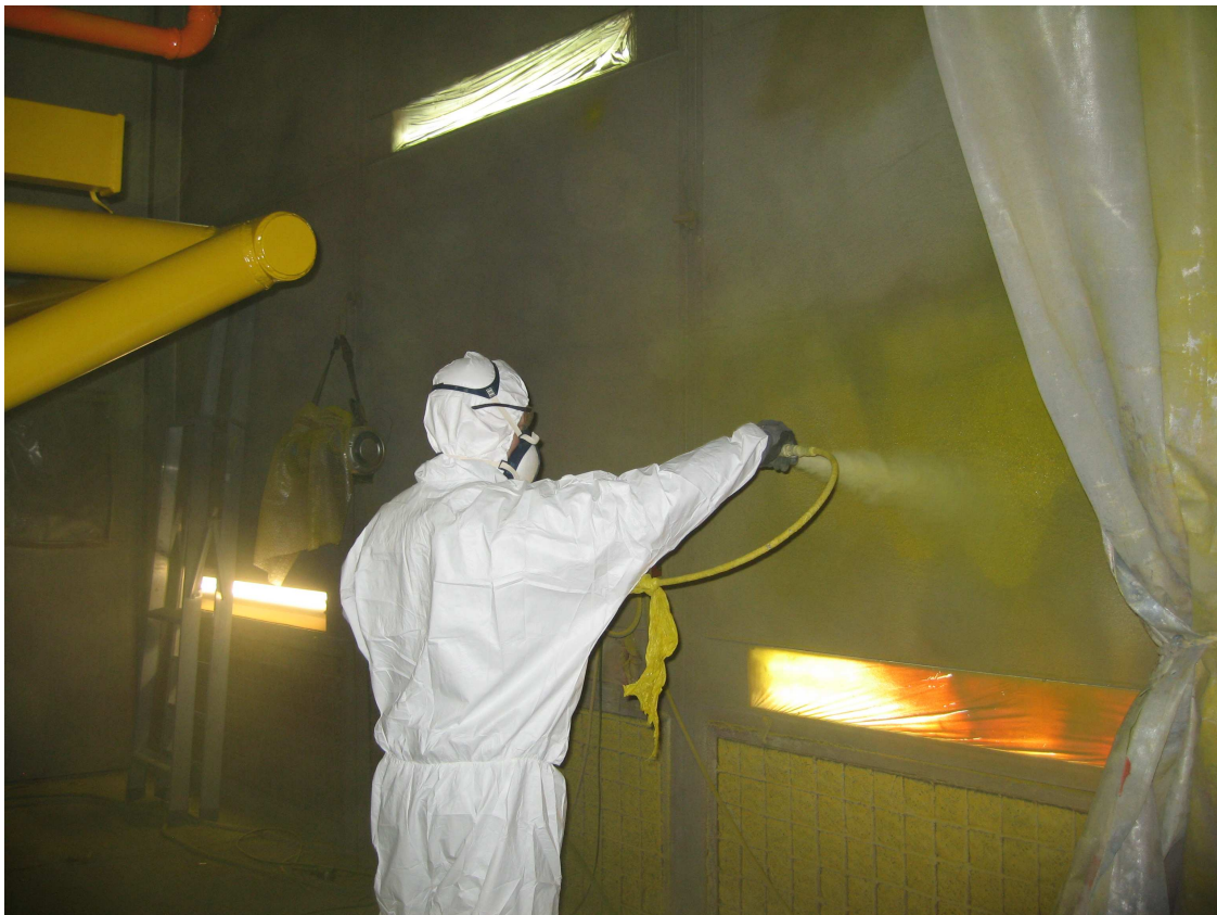
Figur 6.1. Sprøytemaling forårsaker finfordelte partikler av kjemiske stoffer i luften til den som påfører malingen. Verneutstyr er nødvendig for å unngå at stoffene tas opp i kroppen. Denne overflatebehandleren har åndedrettsvern for å unngå å få stoffene inn i lungene, og bruker hansker og kjeledress for å unngå å få stoffene på huden.
