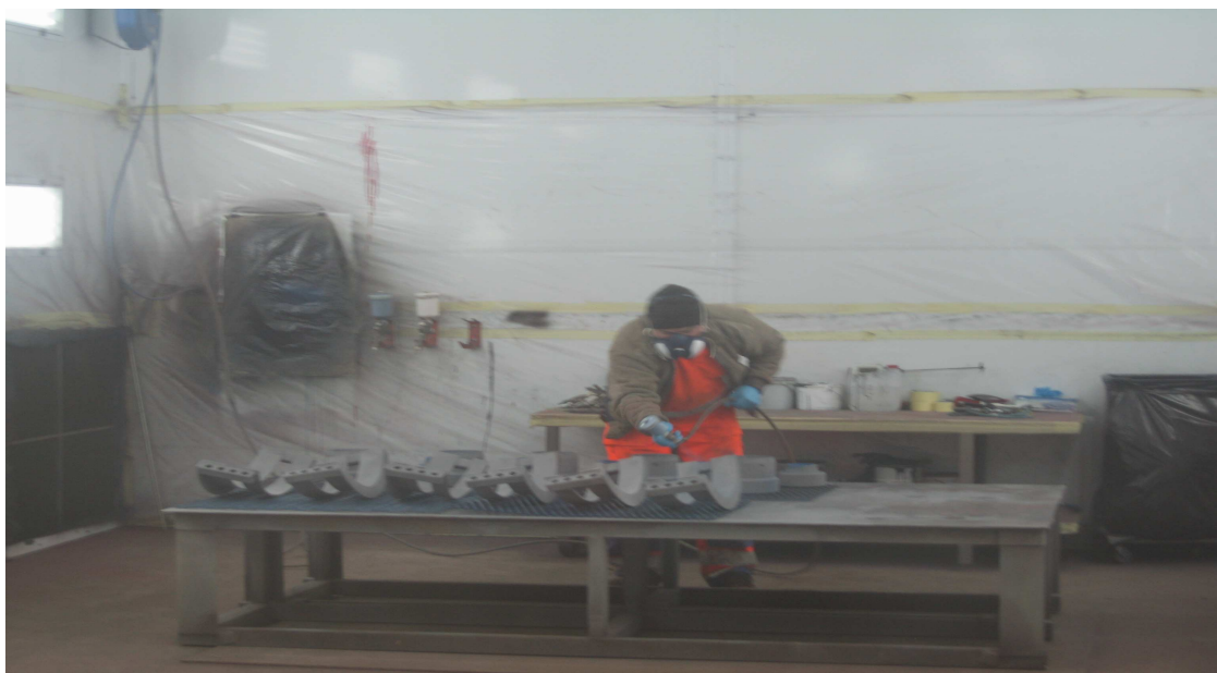
Figur 6.3. Her er en overflatebehandler som lakker inni en lakkeringsboks. Selv om ventilasjonen her er spesielt god, bruker han åndedrettsvern, hansker og kjeledress for å beskytte seg mot de kjemiske stoffene.
