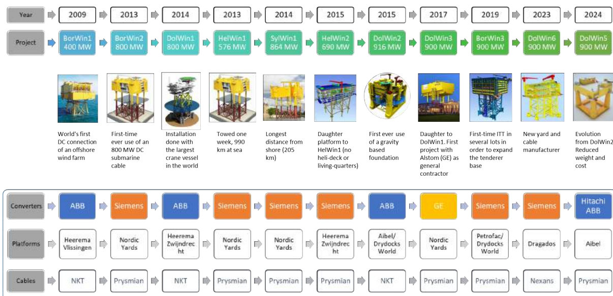
Figur 3-7 Oversikt over konsepter, overføringskapasitet og leverandører for Tennets prosjekter i tysk sektor. Kilde: ÆGE Energy
