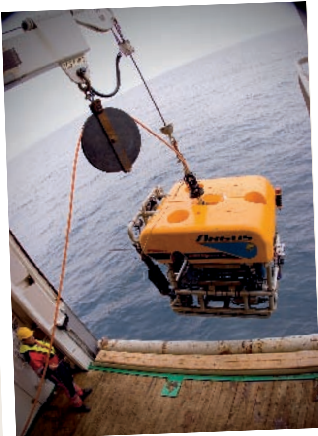
BATHYSAURUS GÅR OVER BORD: Undervassroboten brukar ein halvtime på å dukke ned til sjøfjellet. Med armar av stål og eit kamera som auge orienterer undervassroboten seg rundt. På overflata 600 meter lenger oppe, sit pilotane.
