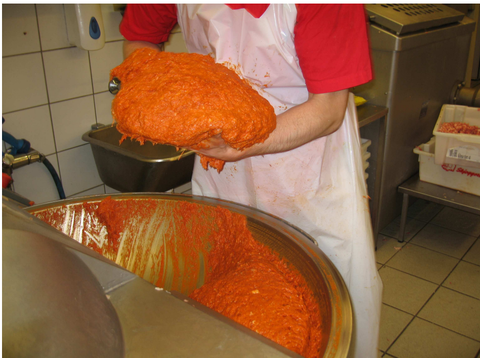
Fig. 7.5. Her har en pøsemaker blandet deig til paprikapølse. Han flytter deretter deigen over til en pøsemaskin. Dette gir stor grad av hudkontakt med fuktig paprikaholdig kjøttdeig som gir risiko for eksem både på hender og armer, og for utvikling av paprika-allergi.
