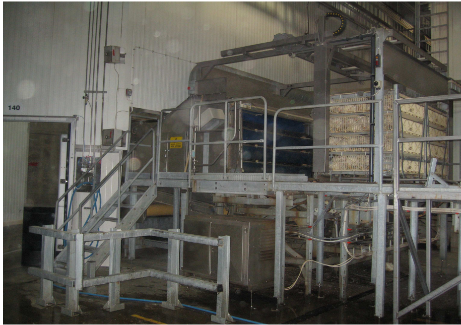
Fig.6.8. Bildet er fra et slakteri for fjørfe. Til høyre ser vi bur som er tettpakket med levende kyllinger. Fjærene kan gi allergier, og det er derfor viktig å ha automatiske systemer, slik at færrest mulig puster inn luft med fjær. Her er burene blitt løftet opp på lasterampen av en truck, og kyllingene sendes automatisk videre inn i slakteriet uten at noen behøver å håndtere dem her. Dette er forebygging av allergi.
