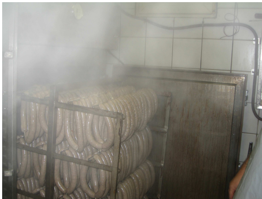
Fig. 6.10. Her ser vi tydelig dampen som velter ut når pølsene tas ut av et skap etter at de er blitt dampkokt. Her burde det ha vært et avtrekk slik at de ansatte ikke puster inn denne dampen. Pølsene kan inneholde forskjellige krydder som lett kan gi allergier.
