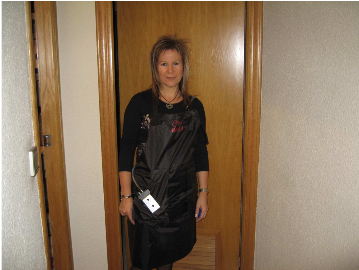
Fig. 6.5. Arbeidstaker som bærer et måleinstrument som kan måle forurensing i luft. Hun har en pumpe i lommen, og det går en slange opp under hennes høyre arm opp til venstre skulder, der luft suges inn.
