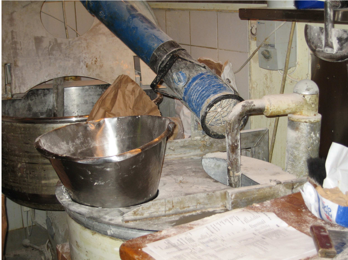
Fig. 6.2. Provisorisk, men det fungerer! Her ser vi toppen av et eltekar som blander bolledeig, der punktavsug er plassert over. En bolle til venstre fungerer som lokk, istedenfor et som mangler. Begge deler er bra for å unngå melstøv i bakeriet. Det er viktig å holde det rent der man baker, ikke bare av hygieniske grunner. Hvis det blir sølt mel stadig vekk, og dette blir liggende rundt omkring, vil støvmengden i rommet fort øke.
