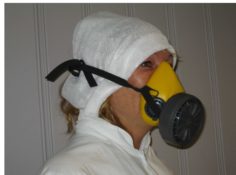
Figur 8.2. Her vises en maske som kan brukes mange ganger, med utskiftbart filter.
