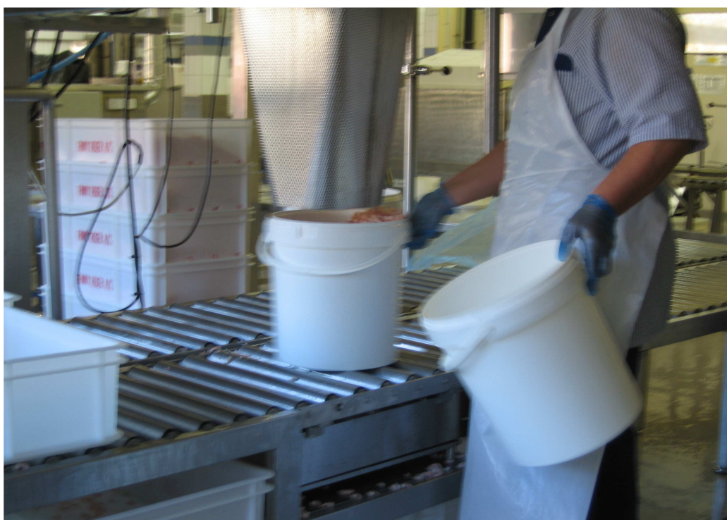
Fig. 7.10. Automatiske nedslippsystemer fra silo reduserer kontakten med rekene, og reduserer risiko for allergi.
