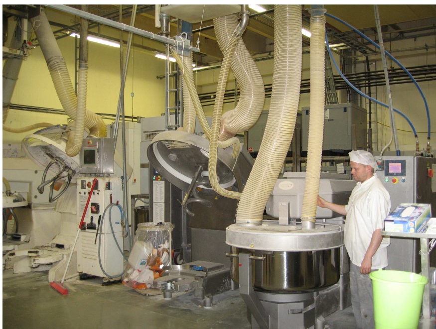
Fig. 6.3. Fylling av eltekarene med mel og annet skjer her ved elektronisk styring. Det betyr at lokket på eltekarene kan være på under hele denne prosessen, og de kan fortsatt være på når eltingen pågår.
